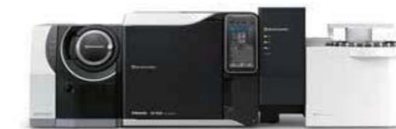
TD-30系列热脱附进样系统通过加热样品管，使管内已吸附的目标化合物自动脱附，经冷阱浓缩后，再次加热释放，进入气质系统进行分析，适用于大气、塑料等各类样品中痕量挥发性有机物(VOCs)分析。
